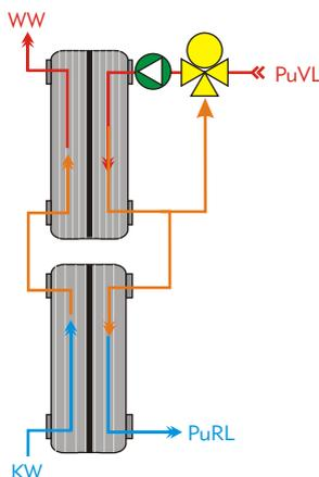
Zwei Wärmetauscher in Serie, für maximale thermische Länge um optimale Temperaturübertragung zu erreichen. Im Puffervorlauf ein Mischventil, um den Puffervorlauf mit dem abgekühlten Wasser aus dem ersten Wärmetauscher herunter zu mischen und zudem die Pufferwassermenge auf die Frischwasserzapfmenge anzupassen.
